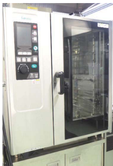
写真4 スチームコンベクションオーブン
